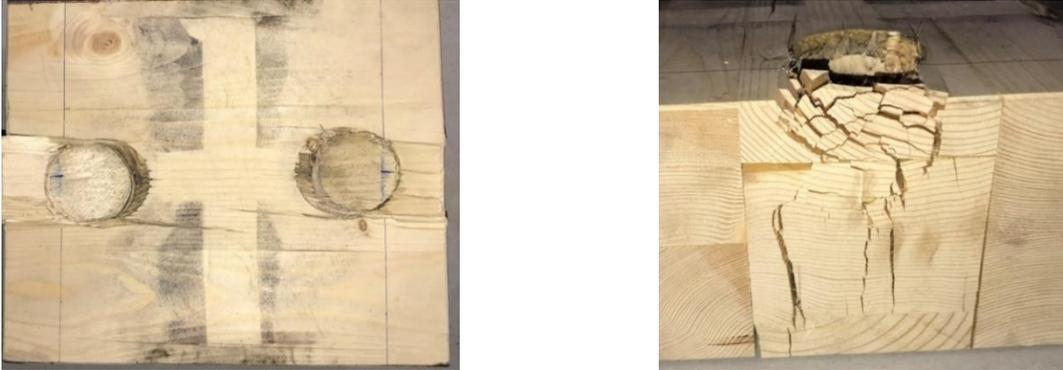
**Abbildung 14 Schadensbild eines Holzblocks aus einem Vorversuch**
