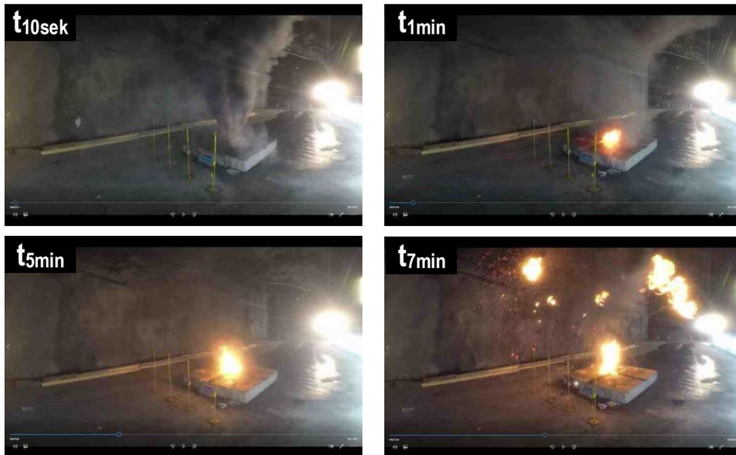
Abbildung 26 Reaktion des Batteriemoduls zu verschiedenen Zeitpunkten nach Beschädigungsbeginn in Versuch 2 (Sicht von oben)
