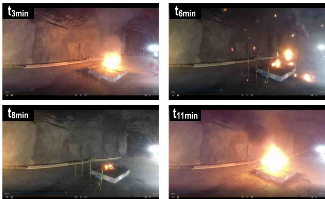
**Abbildung 35** Reaktion des Batteriemoduls zu verschiedenen Zeitpunkten nach Beschädigungsbeginn in Versuch 4 (Sicht von oben)
