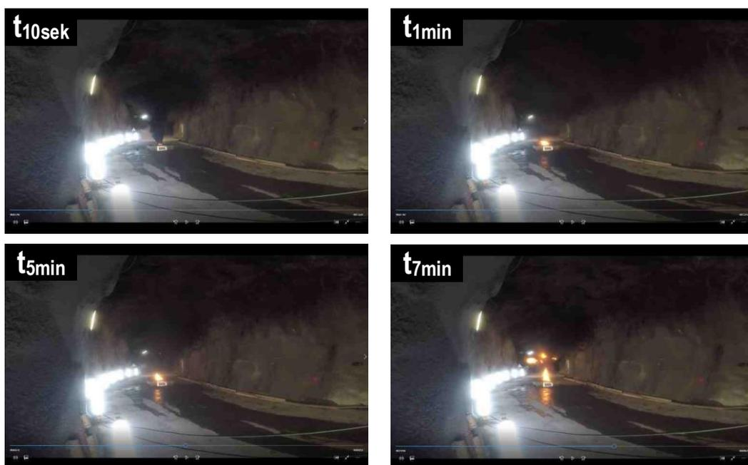
Abbildung 27 Reaktion des Batteriemoduls zu verschiedenen Zeitpunkten nach Beschädigungsbeginn in Versuch 2 (Sicht von unten)
