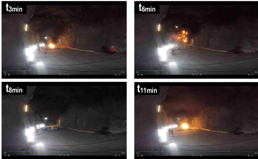
Abbildung 36 Reaktion des Batteriemoduls zu verschiedenen Zeitpunkten nach Beschädigungsbeginn in Versuch 4 (Sicht von unten)
