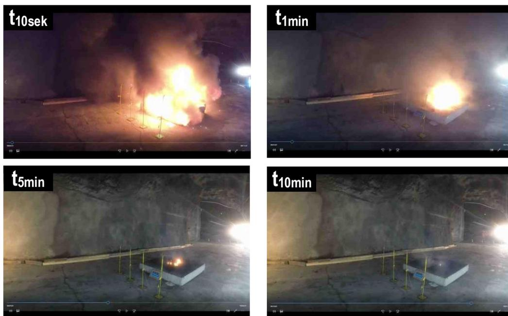
**Abbildung 22** Reaktion des Batteriemoduls zu verschiedenen Zeitpunkten nach Beschädigungsbeginn in Versuch 1 (Sicht von oben)
