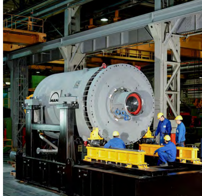
■ Beispiel eines Radialverdichters (rechts) und einer Axialturbine (links), wie sie in einem Druckluftspeicher zum Einsatz kommen könnten. Solche Kompressoren und Turbinen finden heute breite Anwendung im Öl-/Gasgeschäft, in industriellen Prozessen etwa bei der Stahlherstellung oder bei der Zerlegung von Luft in Stickstoff und Sauerstoff. Quelle: MAN Energy Solutions Schweiz AG
