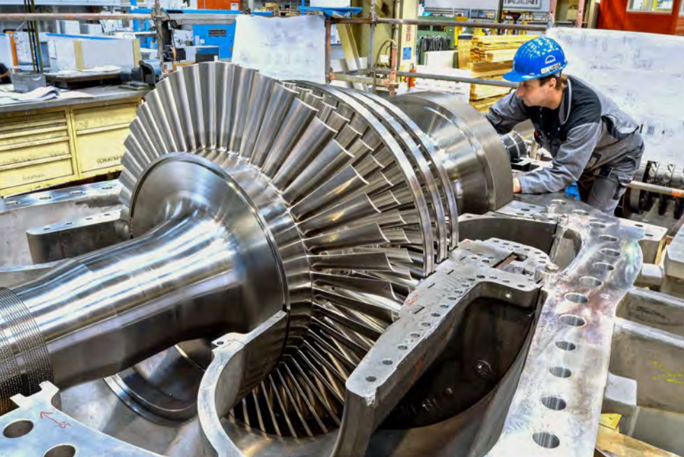
■ Beispiel eines Radialverdichters (rechts) und einer Axialturbine (links), wie sie in einem Druckluftspeicher zum Einsatz kommen könnten. Solche Kompressoren und Turbinen finden heute breite Anwendung im Öl-/Gasgeschäft, in industriellen Prozessen etwa bei der Stahlherstellung oder bei der Zerlegung von Luft in Stickstoff und Sauerstoff. Quelle: MAN Energy Solutions Schweiz AG
